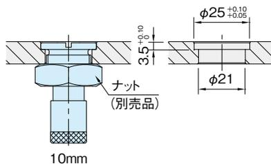
10mm～32mmのベースにはねじ込みで取付けてください。
