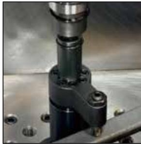
注) ナットランナーで使用する際に、アングランプエンドに当てて停止させる場合の設定トルクは、許容締付トルクの50%以下としてください。
