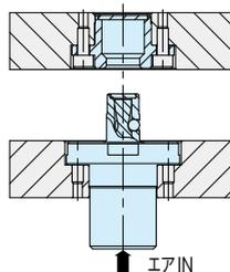
エアを供給すると、クサビが上がってボールのロックが解除され、アンクランプ状態になります。
