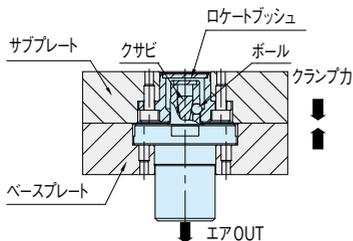
エアを排出するとスプリングの力でクサビが下がり、ボールを強く押し出してロケートブッシュを引込みます。エアの無い場所でもクランプ状態を維持します。
